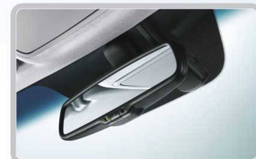
آینه الکتروکرومیک داخل کابین جهت راحتی دید راننده در شب
